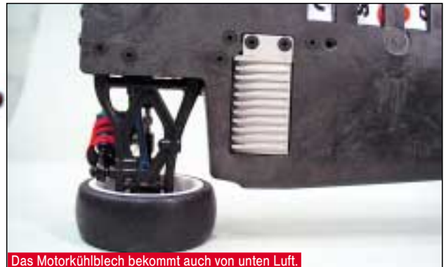
Das Motorkühlblech bekommt auch von unten Luft.
