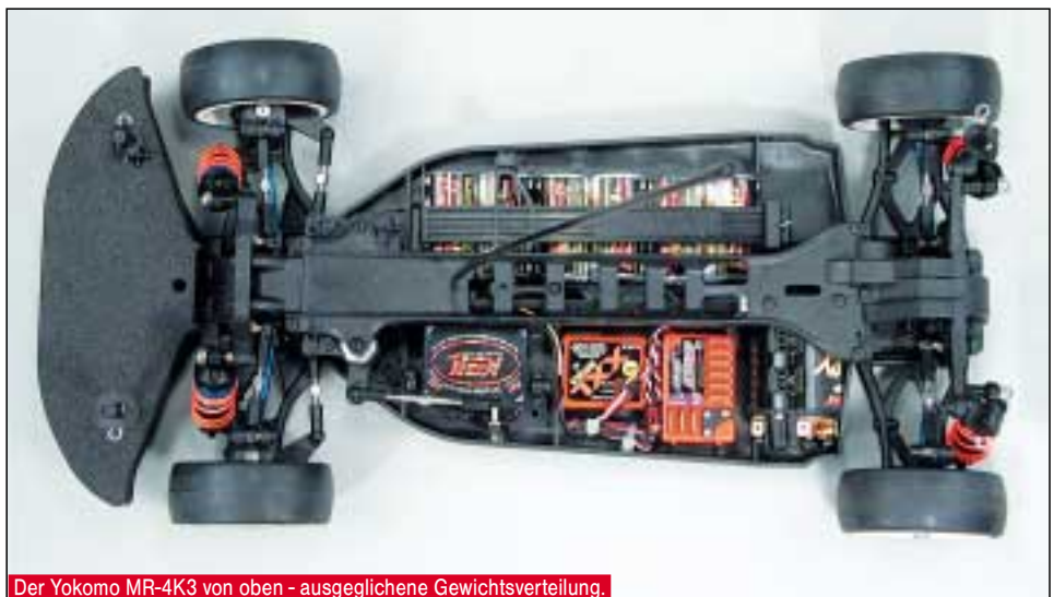
Der Yokomo MR-4K3 von oben - ausgeglichene Gewichtsverteilung.
