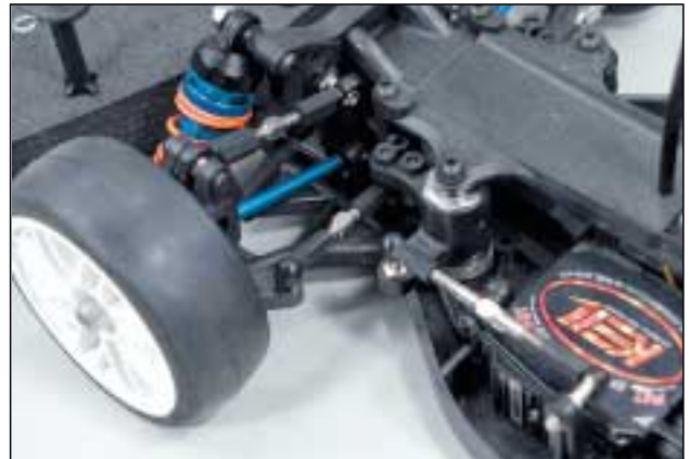
Die Vorderachseinheit mit Aludämpfer, CVD Kardans und Titanspurstangen.
