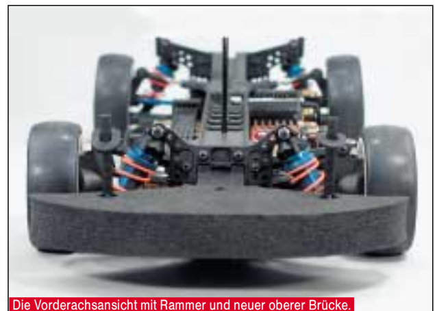
Die Vorderachsansicht mit Rammer und neuer oberer Brücke.
