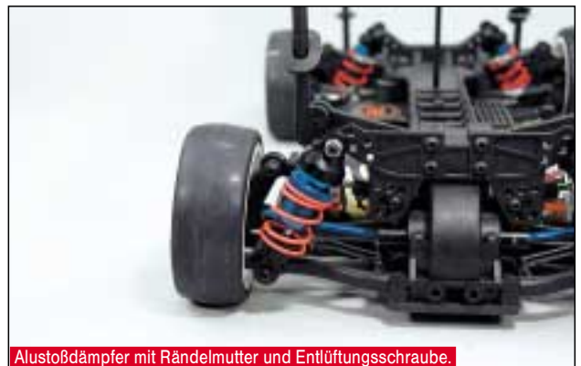
Alustoßdämpfer mit Rändelmutter und Entlüftungsschraube.
